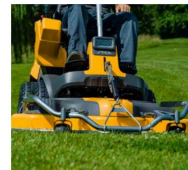
Расположенная спереди режущая дека позволяет скашивать траву в любых уголках вашего сада. Укрепленная рама не только защищает от ударов о препятствия, но может также служить в качестве ручки для переноски.
